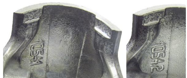
SPROCKET IDENTIFICATION MARKING
